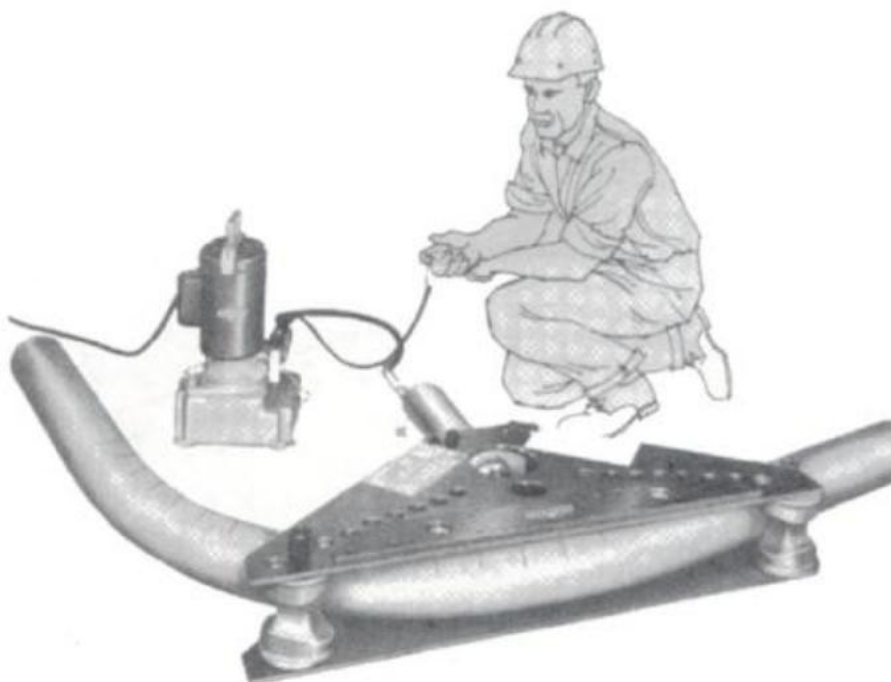
DOBLADOR DE TUBO CONDUIT PARA DIÁMETROS GRANDES
