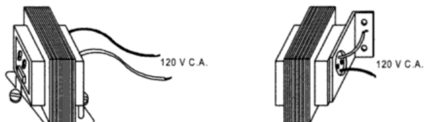
(A) MONTAJE DEL TRANSFORMADOR EN UN BLOQUE DE MADERA
