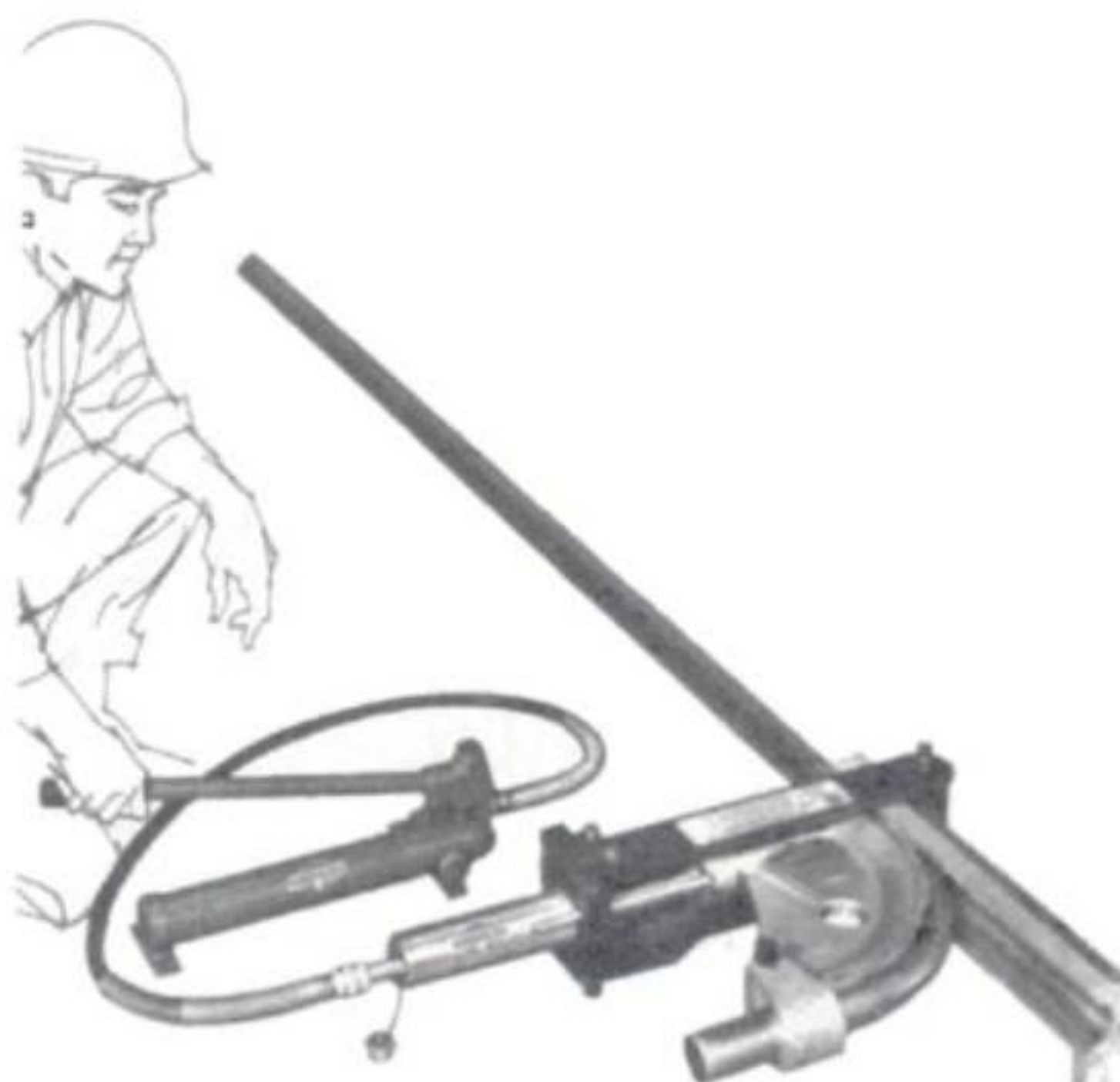
DOBLADOR DE TUBO HIDRAÚLICO PARA TUBO METÁLICO DE 1 ¼ A 2 PULG DE DIÁMETRO
