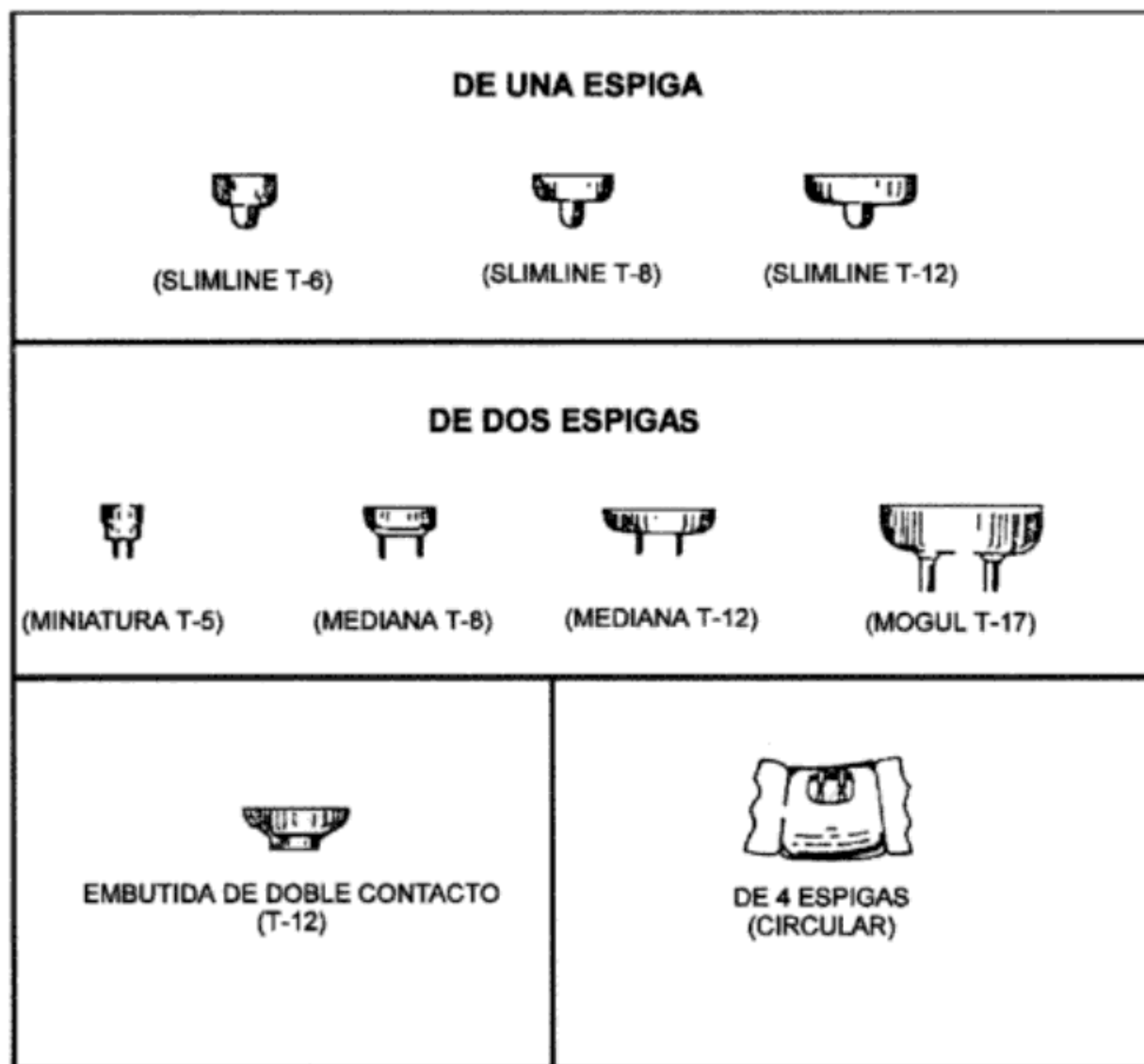
BASES Y TIPOS DE LÁMPARAS MÁS COMÚNMENTE USADAS
