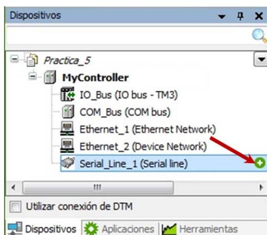
5. Aparece la ventana para añadir el protocolo de comunicación que vamos a necesitar para comunicar el M251 con el M241. Seleccionamos el objeto '**Modbus\_manager**' y lo agregamos al puerto serie 1.
