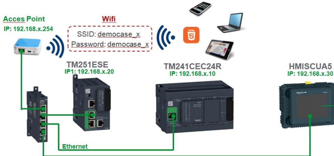
Allí donde pone 'x' viene dado en función del número de maleta. Ejemplo si tenemos la maqueta de práctica que tiene el nombre de red '**democase\_8**', significa que las direcciones IP's de esa maqueta concreta será **192.168.80.254** para el **Acces point**, **192.168.80.20** para el controlador **M251**, **192.168.80.10** para el controlador **M241** y **192.168.80.30** para el terminal táctil **HMISCUA5**.
