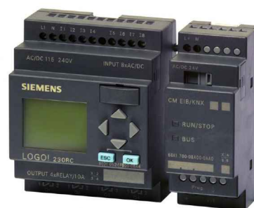
Figura 7.18. LOGO! 230RC con un módulo de comunicación CM EIB/KNX. Cortesía de Siemens.
