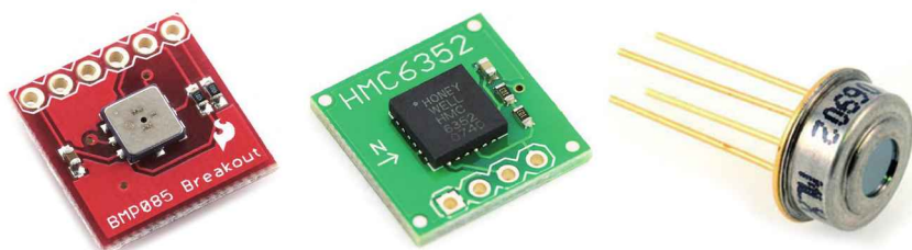
Figura 7.31. Sensores I 2 C barométrico, magnético en dos ejes (brújula digital) y de temperatura y humedad. Cortesía de BricooGeek.
