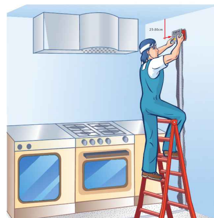
Figura 2.7. Ubicación de sensores de gas butano o propano (GLP) y de gas natural (metano). Cortesía de Gewiss.
