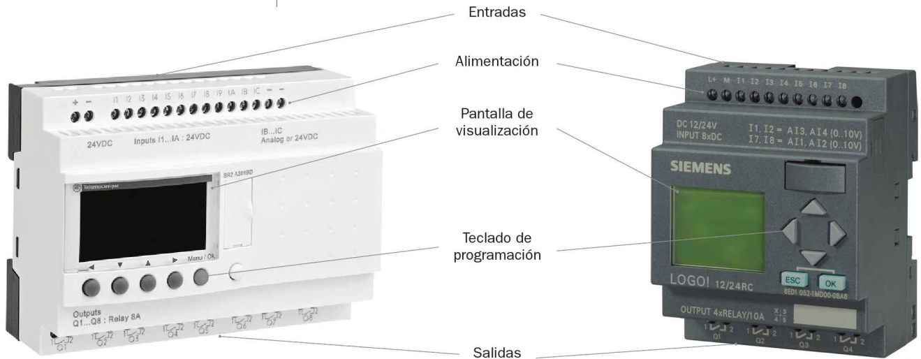
Figura 7.3. Partes de los relés programables LOGO! y Zelio Logic. Cortesía de Siemens y de Schneider Electric.
