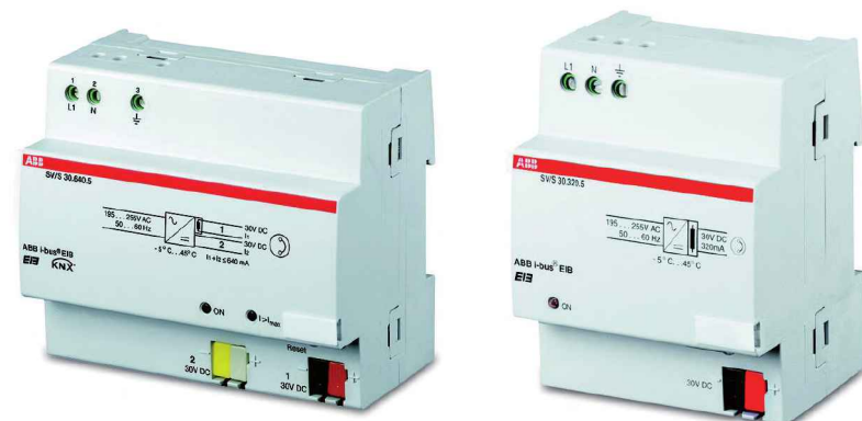
Figura 5.6. Fuentes de alimentación con cebador de 640 (la más habitual) y 320 mA respectivamente. Cortesía de ABB.
