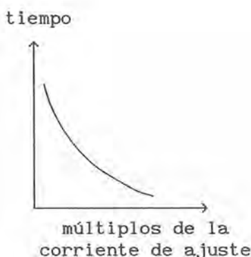
Figura 9.8. Curva característica de un relevador de corriente maximal.
