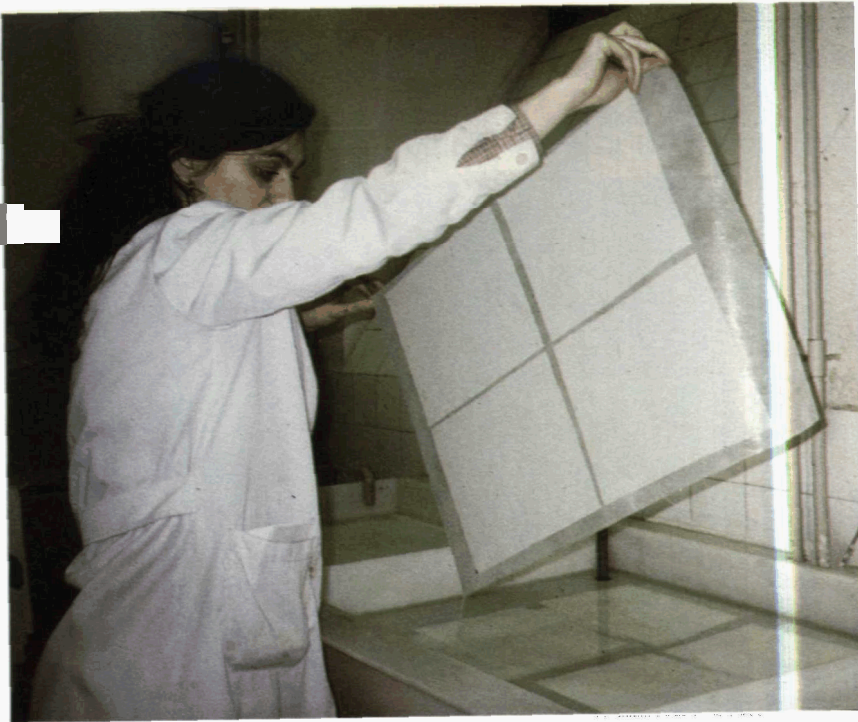
Figura 40. Extracción de las muestras del baño de desacidificación
