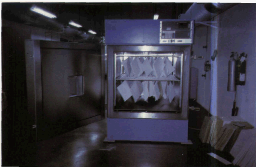
Figura 39. Cámara climática empleada en los ensayos de envejecimiento acelerado
