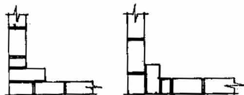
Fig. 4.F Primera y segunda Hilada en una citara apilada.
