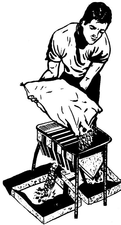
Fig. 1.14 Cuarteo mecánico de los áridos.
