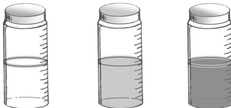
Fig. 1.32 Patrones de colores para determinar las impurezas orgánicas.
