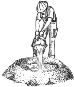
Fig. 3.2 Elaboración manual (vertido del agua)
